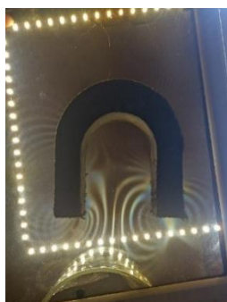
Рисунок 7. Сравнение картин магнитного поля, полученного с помощью железных опилок с картиной магнитного поля экрана-визуализатора.
