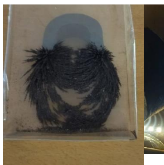
Рисунок 7. Сравнение картин магнитного поля, полученного с помощью железных опилок с картиной магнитного поля экрана-визуализатора.
