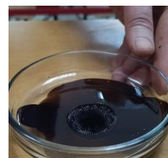
Рисунок 4. Визуализация магнитного поля с помощью ферромагнитной жидкости, приготовленной методом конденсации высокодисперсного магнетита
